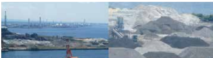
JFE スチールの原料ヤードの一部。広大な土地に石炭・鉄鉱石・スラグ等が大量に野積みされている。
